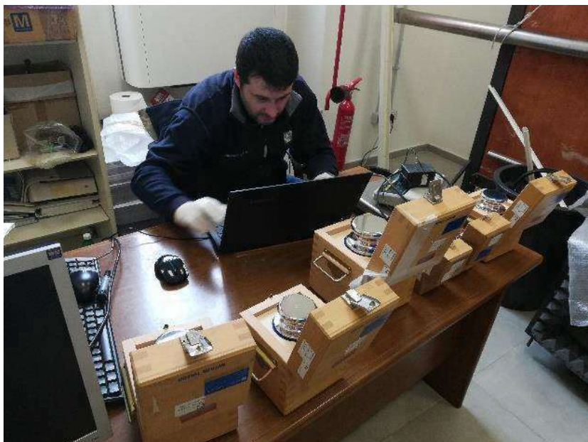
Controllo e taratura bilance
