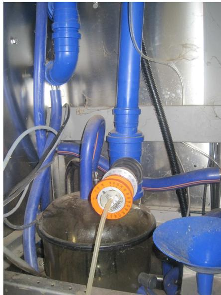
7.3 Aprire il flussometro fino a provocare un abbassamento permanente del livello del vuoto di lavoro di 2 kPa
