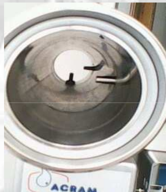
IL SENSORE CHE INDICA LA PRESENZA DEL LATTE (PUO'FUNZIONARE ANCHE DA SONDA DI TEMPERATURA) E LO SPILLATORE
